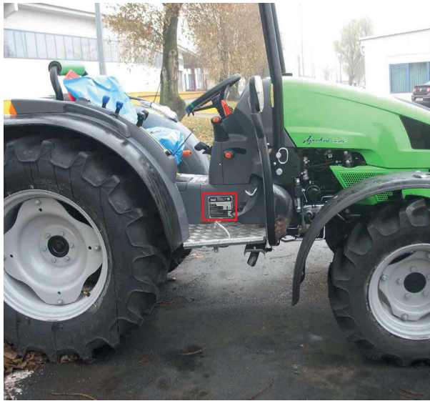
Ryc. 5 i 6. Umiejscowienie i wygląd tabliczki znamionowej. Źródło: zasoby własne
