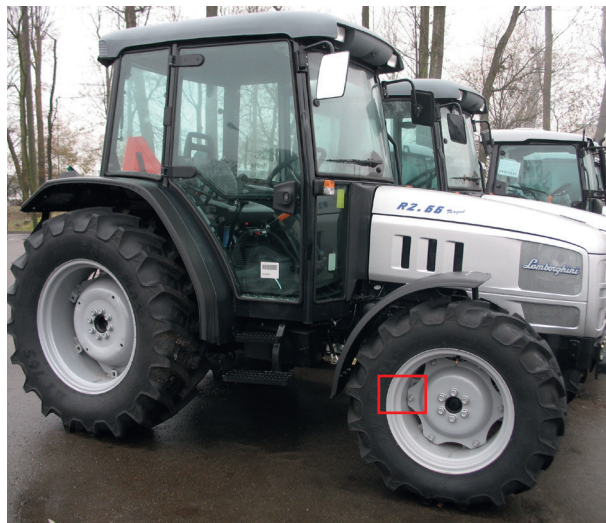
Ryc. 10 i 11. Umieszczenie i wygląd numeru identyfikacyjnego silnika.
