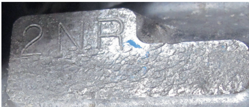
Ryc. 5. Pole numerowe skrzyni w trakcie badań po wstępnym szlifowaniu powierzchni.
