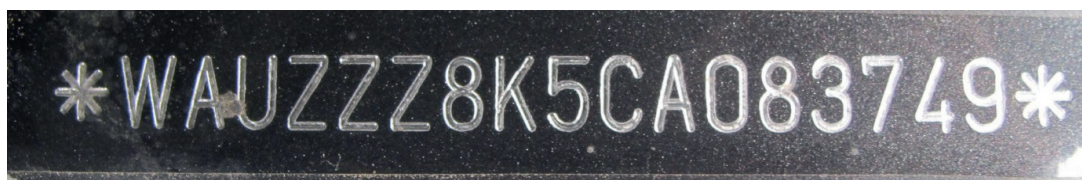
Ryc. 2. Nr VIN przed trawieniem.
