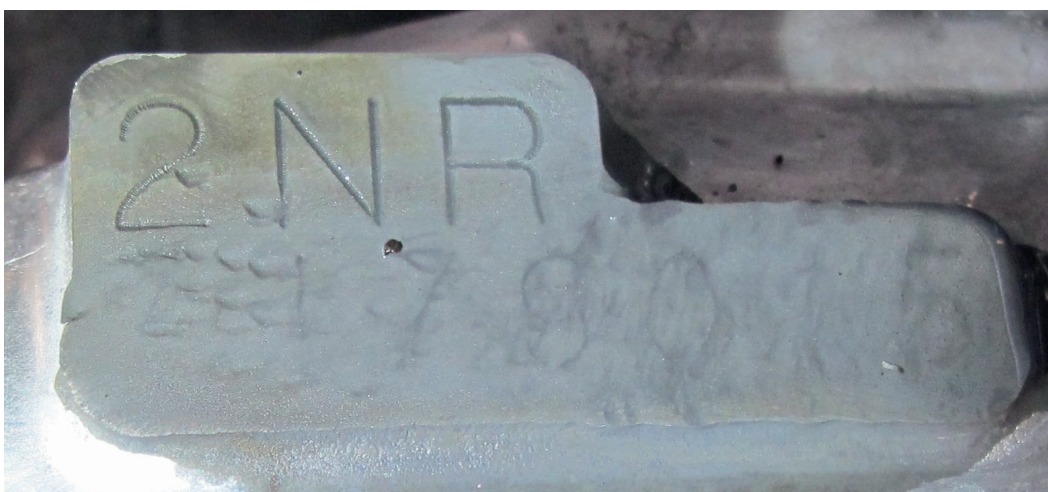
Ryc. 6. Pole numerowe w trakcie trawienia odczynnikami Adlera II.
