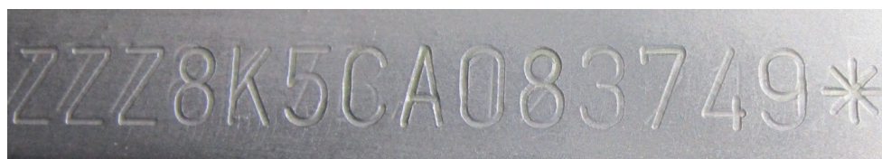
Ryc. 3. Nr VIN po trawieniu odczynnikiem Adlera II
