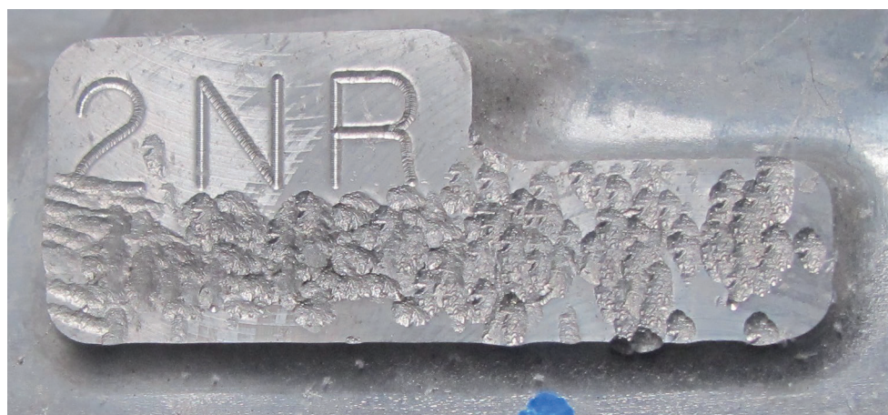
Ryc. 4. Pole numerowe skrzyni biegów przed badaniami.
