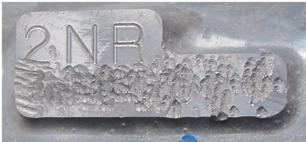
Ryc. 1. Metoda zaspawania pola numerowego lub dość głębokie usunięcie znaków wykonanych metodą dłutowania lub wypalania laserowego powoduje nieodwracalne zmiany i niemożność ujawnienia usuniętych znaków.
