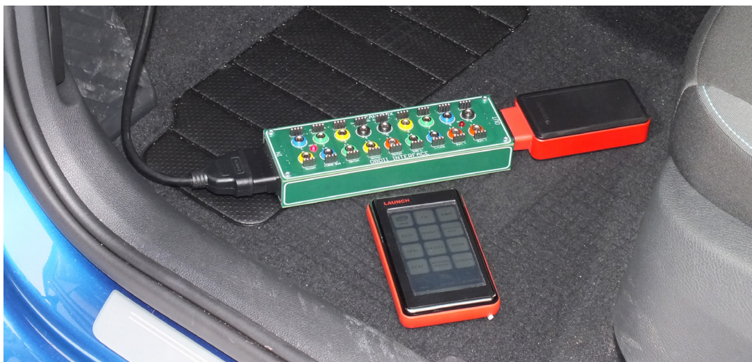
Ryc. 7. Praktyczne wykorzystanie CAN-BOX w samochodzie w połączeniu z testerem diagnostycznym
