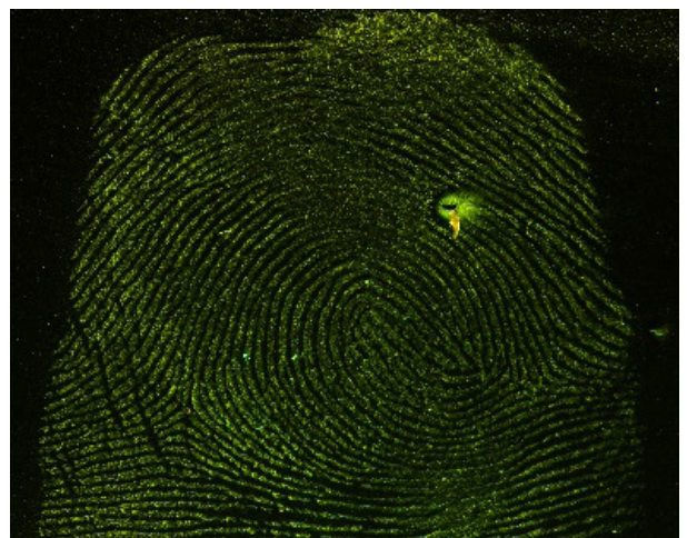
Ryc. 34. Ślad linii papilarnych ujawniony na płytce ceramicznej zawieszoną NANODAK 40, zarejestrowany w świetle niebieskim o długości fali 410 nm, z żółtym filtrem
