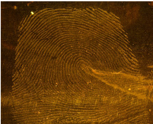
Ryc. 30. Ślad linii papilarnych ujawniony na płytce ceramicznej zawieszoną NANODAK 30, zarejestrowany w świetle niebieskim o długości fali 410 nm, z pomarańczowym filtrem
