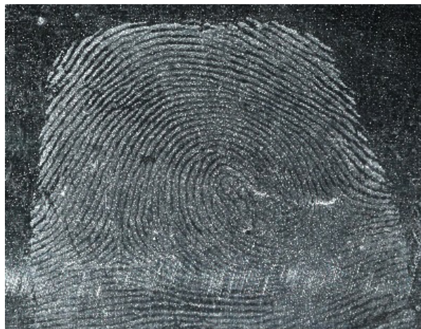
Ryc. 26. Ślad linii papilarnych ujawniony na folii aluminiowej zawieszoną NANODAK 30, zarejestrowany w świetle białym
