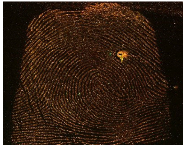
Ryc. 33. Ślad linii papilarnych ujawniony na płytce ceramicznej zawieszoną NANODAK 40, zarejestrowany w świetle UV o długości fali 360 nm, z żółtym filtrem
