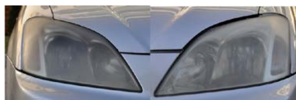
Ryc. 6. Reflektory będące w eksploatacji (zmatowiałe)
