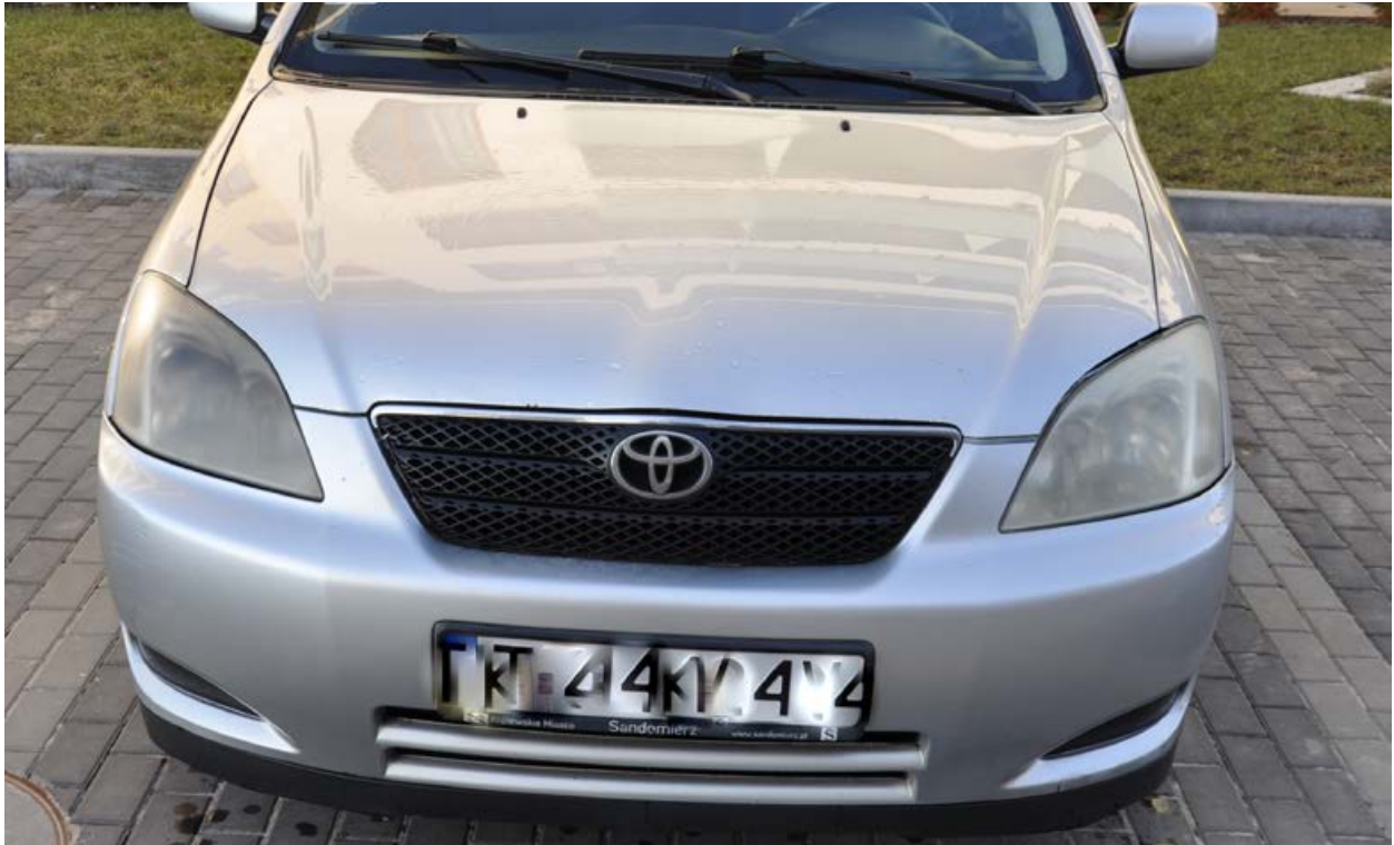
Ryc. 1. Pojazd badawczy z zamontowanymi zmatowiałymi reflektorami
