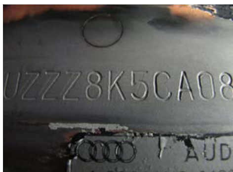
Ryc. 6. Badania niszczące z wykorzystaniem zjawiska rekrytalizacji
