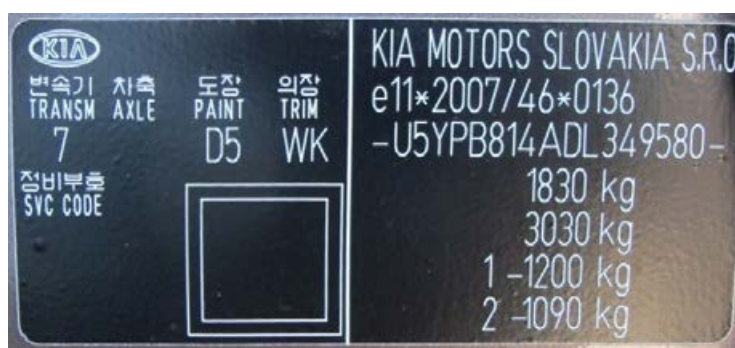
Ryc. 2, 3. Przykłady tabliczek znamionowych wykonanych w formie metalowej blachy oraz naklejki
