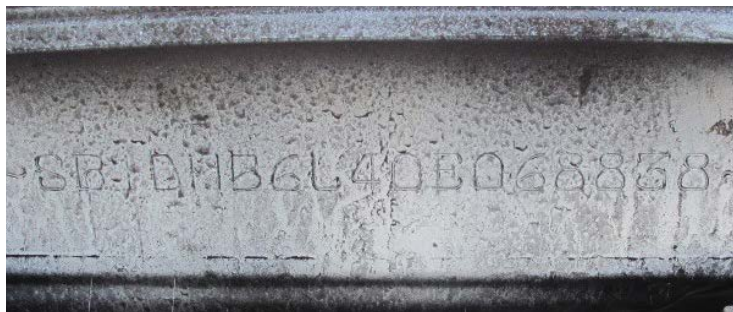
Ryc. 4, 5. Badanie pola numerowego pojazdu z wykorzystaniem defektoskopu stałomagnetycznego
