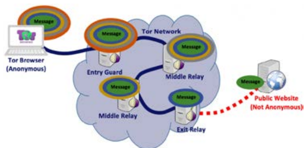
Ryc. 3. Diagram pokazujący jak wiadomość będzie podróżować poprzez sieć TOR dopóki nie dotrze do publicznej witryny internetowej. Klient sieci TOR (przeglądarka Tor Browser) dodaje tyle warstw, ile jest przekąźników w łańcuchu
