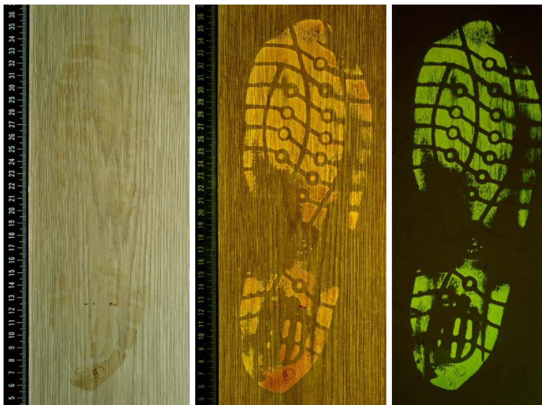
Ryc. 12, 13, 14. Ślad krwawy ujawniony Acid Yellow 7 widoczny w świetle białym (po lewej), we fluorescencji (w środku) i we fluorescencji po przeniesieniu z podłoża na folię żelatynową (po prawej)
