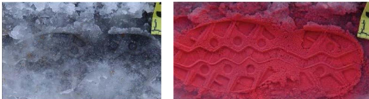
Ryc. 10, 11. Ślad wglębiony w śniegu przed (po lewej) i po kontrastowaniu preparatem Snow Print Wax (po prawej)
