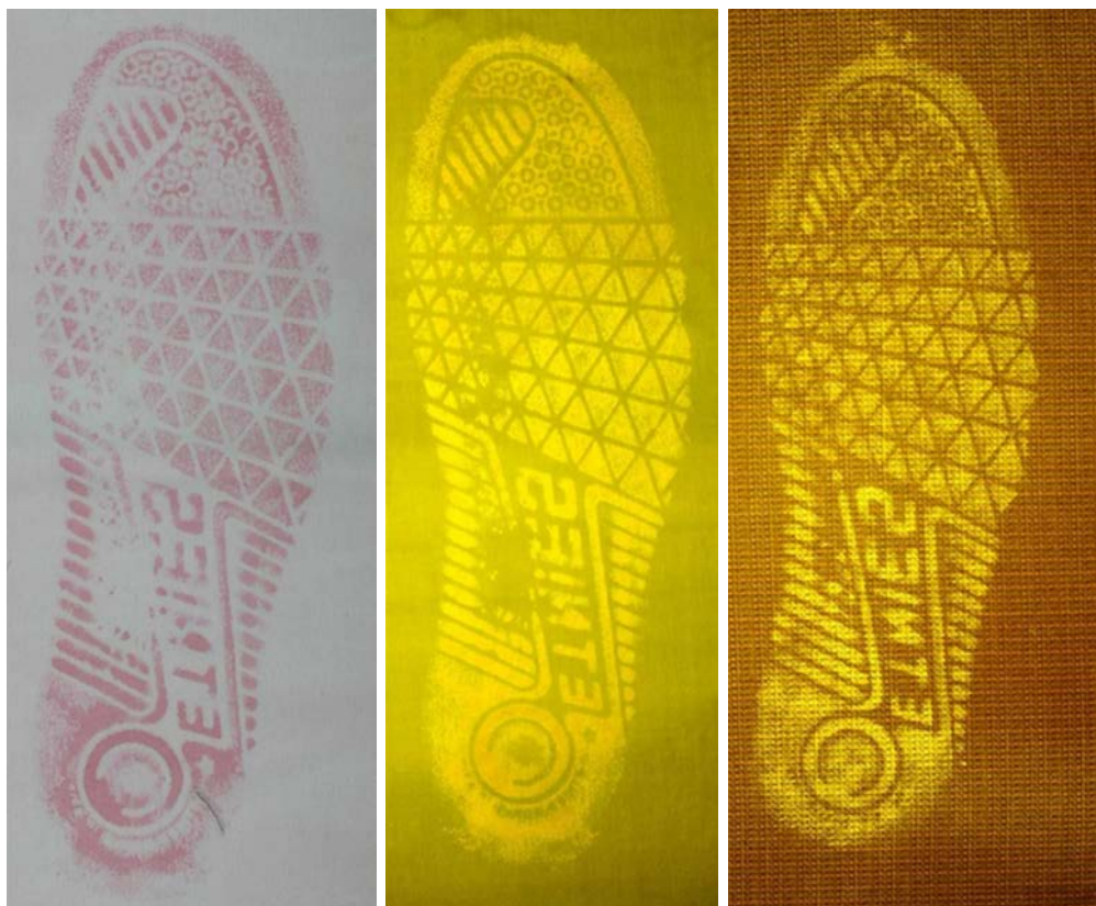
Ryc. 44, 45, 46. Ślady pozostawione moczem na podłożach bawełnianych ujawnione DFO, widoczne w świetle białym (po lewej) i we fluorescencji (w środku i po prawej)
