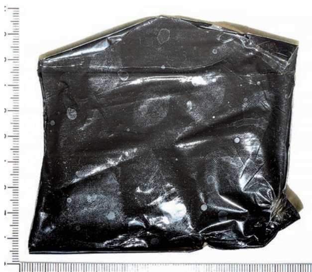
Ryc. 7. Czarna folia streczowa ze śladami ujawnionymi parami kleju cyjanoakrylowego, sfotografowana aparatem cyfrowym.
