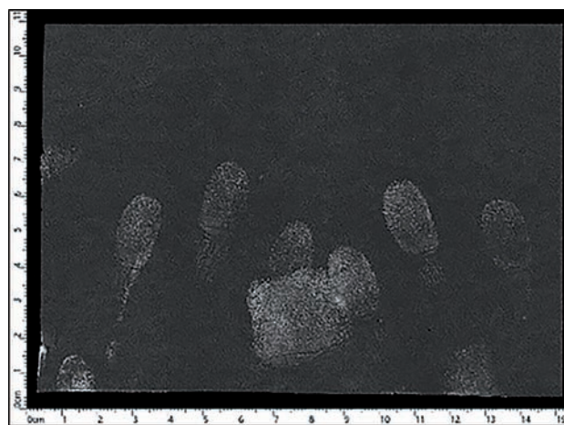
Ryc. 2. Ślady linii papilarnych ujawnione DFO i zeskanowane systemem TrasoScan.
