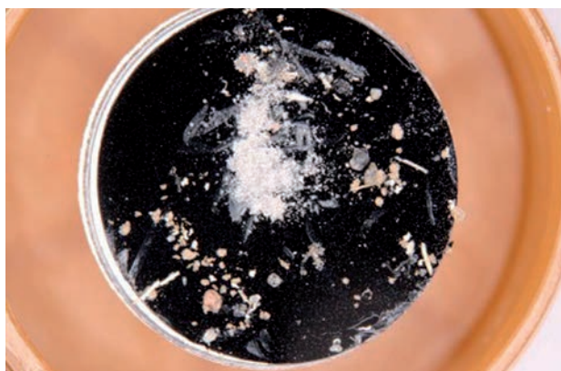
Ryc. 27. Przykładowy materiał naniesiony na stolik do badań SEM.
