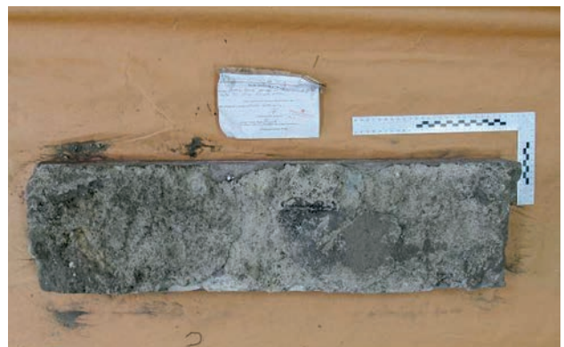
Ryc. 2. Materiał dowodowy – blok betonowy, warstwa spodnia z widoczną zaprawą murarską.
