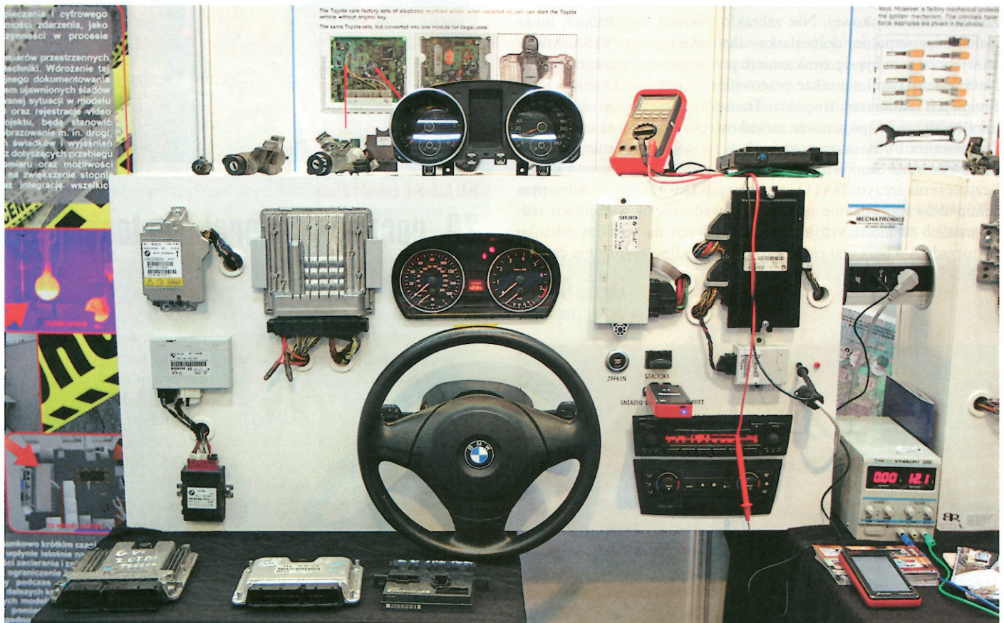
Na stoisku CLKP pokazano stanowisko prototypowe do pozyskiwania w celach procesowych informacji zakodowanych w podzespołach elektronicznych samochodów. Przy jego użyciu można ustalić m.in. zapisany w nich tzw. VIN, czyli numer identyfikacyjny pojazdu
