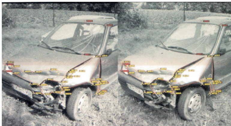
Zdj. 1. Zorientowana wzajemnie para zdjęć o wspólnym obszarze pokrycia z wykonaną stereodygitalizacją deformacji nadwozia (ilustracja zaczerpnięta z artykułu Problemy Kryminalistyki nr 253/2006; zdj. A Sikora)
